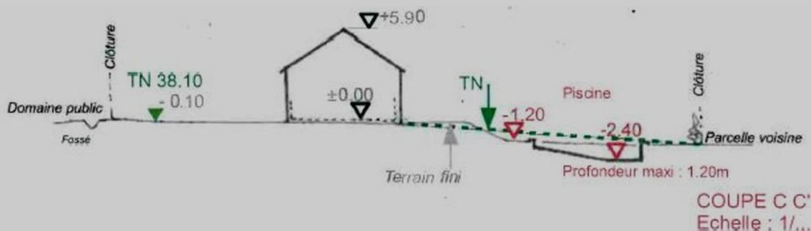
\*\*\* Même si le terrain est plat le profil du terrain doit apparaître avec la mention TN
